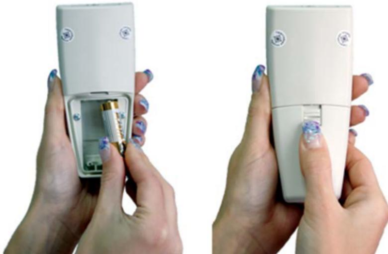
Abb. 4. Batteriewechsel
